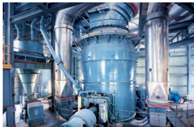
Eine QMC 2 -RD in Frankreich: Sie stellt OPC-Zement mit Feinheiten < 10 % R 25 µm her.
